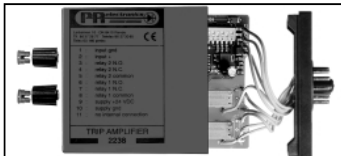
Abb. 3: Herausnehmen der Platine zur Veränderung von Schaltern und Überbrückern.
