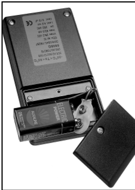
Image 1 : Mettre en place la pile.
